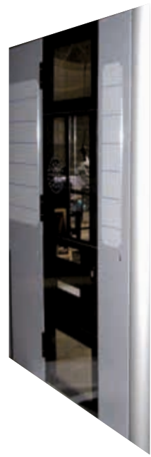
Trennwandtüre mit Werbeflächen und Wartungsklappe Bombardier
